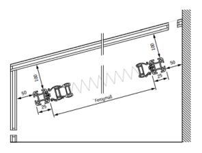
Bitte Lüftungsschlitze oben und unten berücksichtigen.
