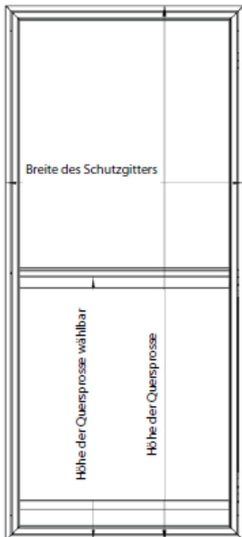
Ausgemessen wird immer das Außenmaß des Schutzgitters – das für die Fertigung erforderliche Maß. Die anderen Maße sind nur empfohlen – die Lücke oben/unten min. 5 mm. Unten kann der Schutzgitter direkt auf dem Boden stehen.
